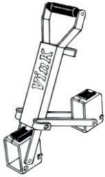
VVKR13 krikgedeelte met begrenser mécanisme de lèvee avec blocage
