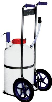
In het voorraadvat kan de medicatie met water worden gemengd. Het vat wordt door middel van een driewegkraan gevuld. Een roerstaaf zorgt ervoor dat de medicatie goed in oplossing blijft en niet neerslaat. Door middel van een pomp kan de medicatie in de leidingen gedoseerd worden.
